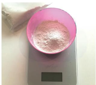
7. Fugenmasse nach Produktanleitung abwiegen.
