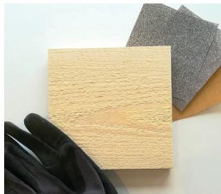
1. Holzbrett mit Schleifpapier bearbeiten. Evtl. zum späteren Aufhängen, mit der Bohrmaschine, an der oberen Kante des Holzbretts zwei Löcher bohren.
