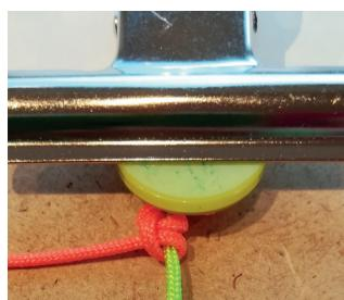
8. Serrer le nœud (les points 4 à 8 décrivent un nœud d'ancrage gauche avec corde de guidage, avec un double demi-coup).
