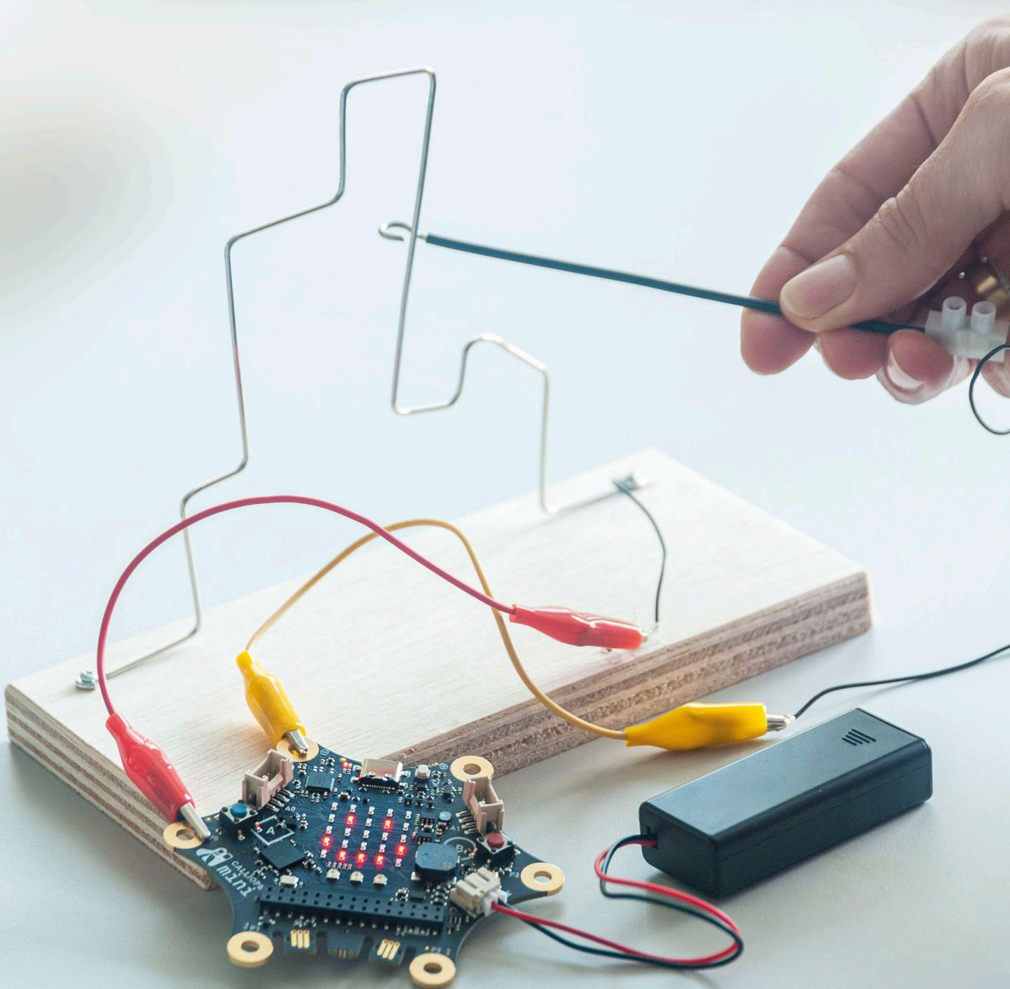
Erweitere diesen Bausatz mit einem Controller. Hierfür werden im Grundaufbau zwei Krokodilklemmen oder beliebige andere Leitungen benötigt.
