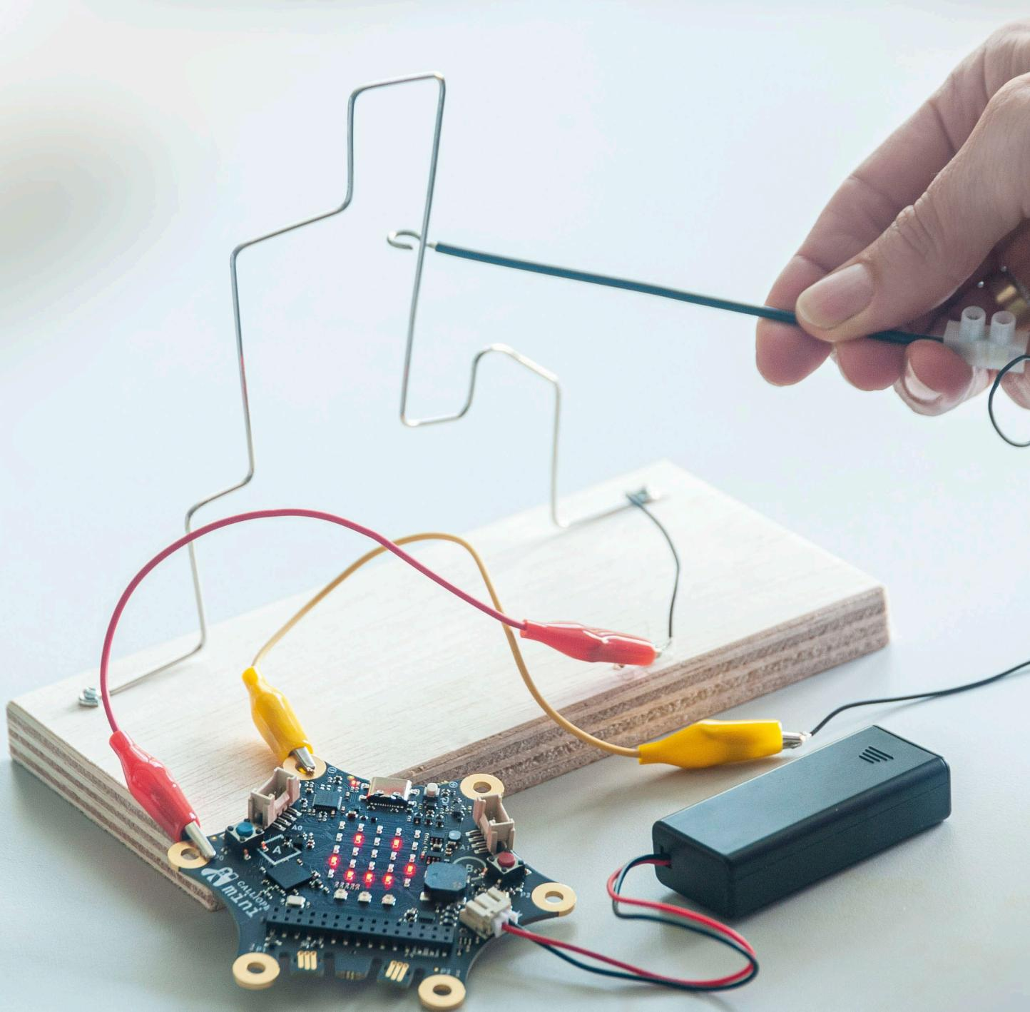
Aporta todavía más valor pedagógico a este kit con una placa (por ejemplo, Micro:bit). Necesitarás dos pinzas de cocodrilo o cualquier otro tipo de cable para el montaje.
