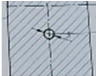
2. Die 2 Bohrungen pro Acrylglassstreifen mit Folienstift mittig anzeichnen. Bohrloch mindestens 5mm von den Enden entfernt setzen, aber möglichst weit an den Enden.
