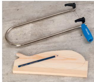
1. Dessinez un poisson sur une planche de bois. Fixez la planche avec un serre-joint et découpez-la avec une scie à chantourner.
