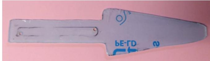
3. Heber aussägen und Kanten mit der Feile, Ziehklinge, Schleifpapier, Nassschleifpapier und der Polierscheibe bearbeiten.
